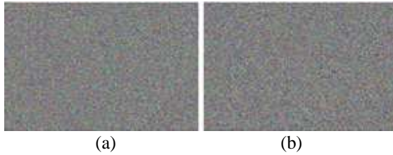
Gambar 7. Hasil Dekripsi (a) Logistic Map (b) PWLCM dengan Selisih Nilai Kunci 0.0000000001 dari Kunci Enkripsi
